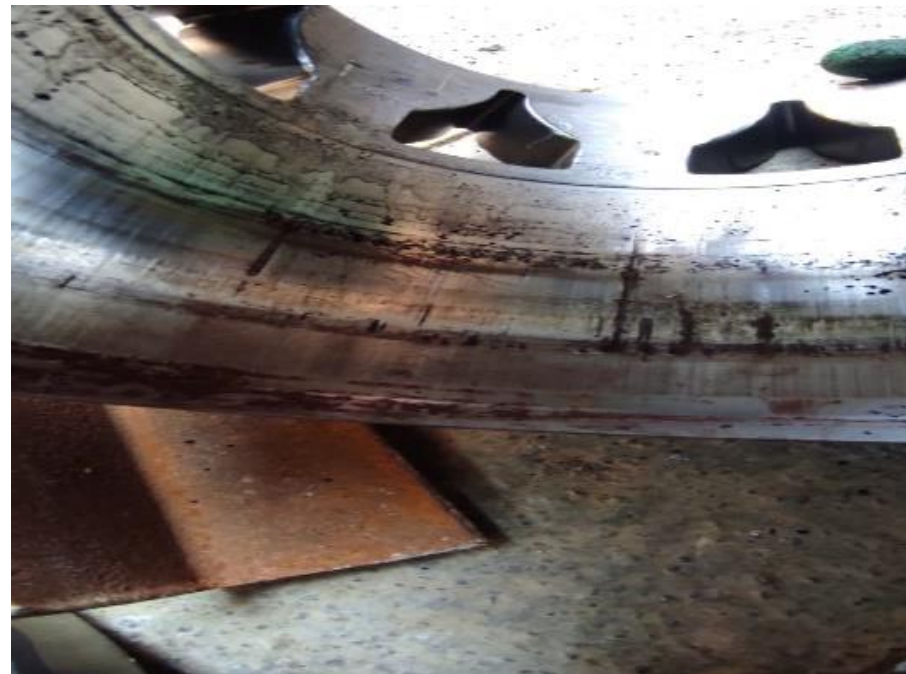
آثار آسیب‌های ناشی از ذرات بر روی قطعات داخلی شیر
