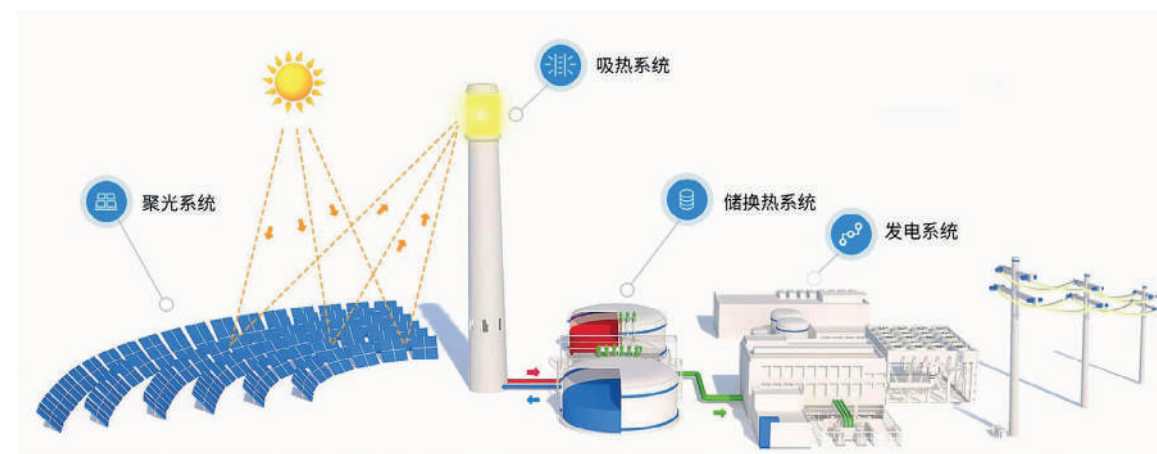
شکل ۵. طرح شماتیک آینه‌های CSP با برج نمک مذاب و ذخیره انرژی حرارتی
